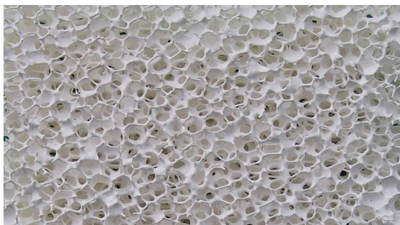
Obr. 4. Keramická pórovitá hmota na báze oxidu hlinitého sa používa ako „nosič“ katalyzátorov, ktoré sa vytvárajú vo forme tenkých povlakov.
